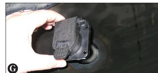
6. Fixer le faisceau au véhicule à l'aide des attaches de câble fournies.
