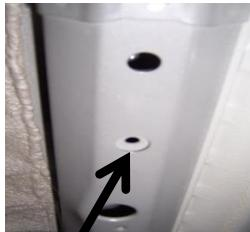
Perfore para agrandar los orificios en la capa interior de los largueros del bastidor si es necesario
