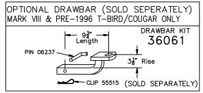
USE ONLY THE DRAWBAR SHOWN FOR CORRECT BUMPER CLEARANCE AND HEIGHT. DRAWBAR MUST BE USED IN THE RISE POSITION ONLY.
