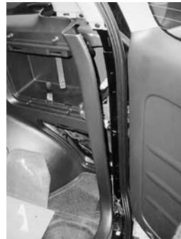
3. Des deux côtés, conducteur et passager, repérer le faisceau de fils des feux arrière du véhicule. Le faisceau de fils des feux arrière comportera, des deux côtés, un point de branchement correspondant aux extrémités du connecteur en T. Débrancher ce connecteur, en veillant à ne pas briser les pattes de verrouillage. Toutes les surfaces de contact des connecteurs doivent être propres et dépourvues de saleté.
