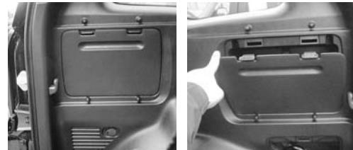
2. Retirer partiellement les panneaux de garniture intérieurs arrière sur les côtés conducteur et passager du véhicule. Plusieurs attaches de panneau de garniture devront être retirées pour enlever les panneaux. Mettre de côté les articles qui ont été enlevés en veillant à ne pas les endommager.
