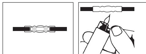
Aplique calor directamente al empalme, desde el centro hacia los bordes, utilizando una pistola de aire caliente u otra fuente, hasta que el tubo se recupere y el adhesivo fluya. Deje enfriar antes de inspeccionar el empalme y revisar la integridad.
