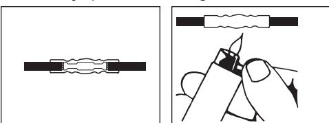
À l'aide d'un pistolet à air chaud ou d'une autre source, appliquer la chaleur directement sur la connexion sertie en travaillant
